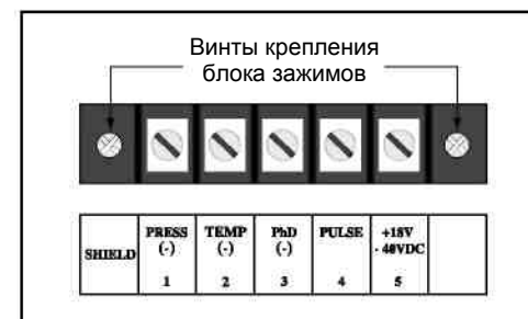
Рис.6.9. Расположение винтов крепления блока зажимов
