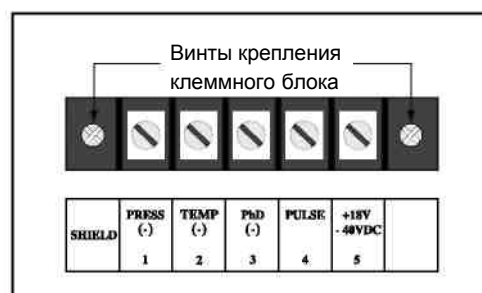
Рис.6.30. Расположение винтов крепления блока зажимов
